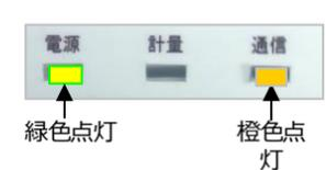
→H2V Controllerの通信ランプ(橙)が点灯していない(消灯、2回点滅、3回点滅している)とき
