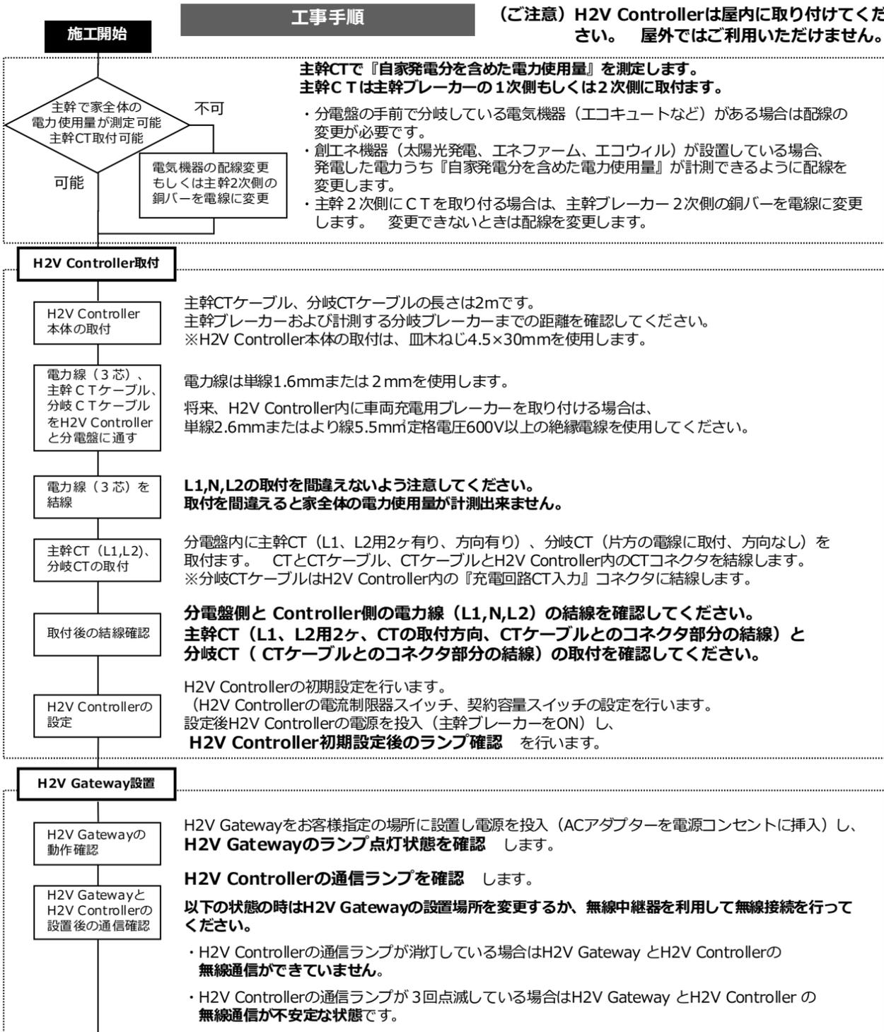
主幹CTで『自家発電分を含めた電力使用量』を測定します。主幹CTは主幹ブレーカーの1次側もしくは2次側に取付ます。
